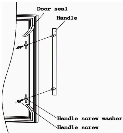
2. Siga el esquema a continuación para insertar todos los accesorios de instalación del tirador:
