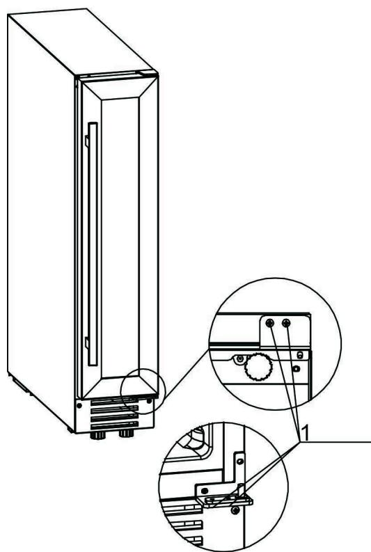
2. Retire la cubierta de la bisagra superior izquierda.
