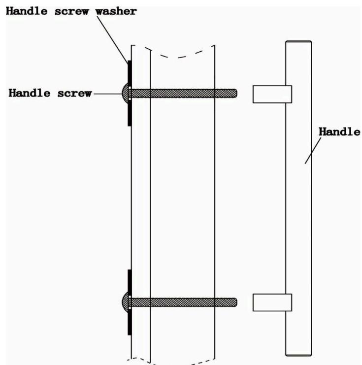
3. Alinee el tirador con los tornillos y apriete. El tirador debe encajar bien contra el marco de la puerta (NO apriete demasiado los tornillos ya que esto puede dañar el conjunto del tirador y el marco o el vidrio de la puerta).
